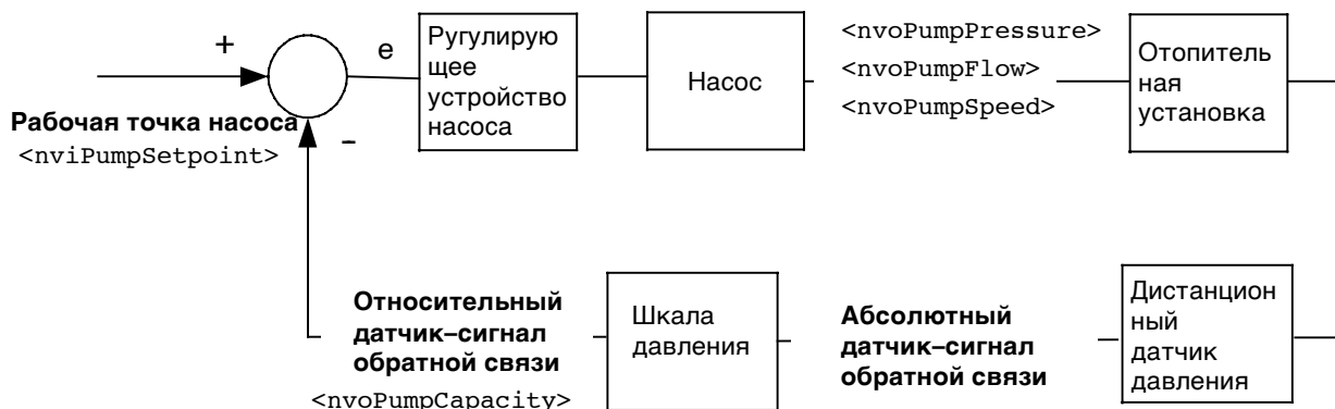
Рис. 11: Применение дистанционного датчика давления
